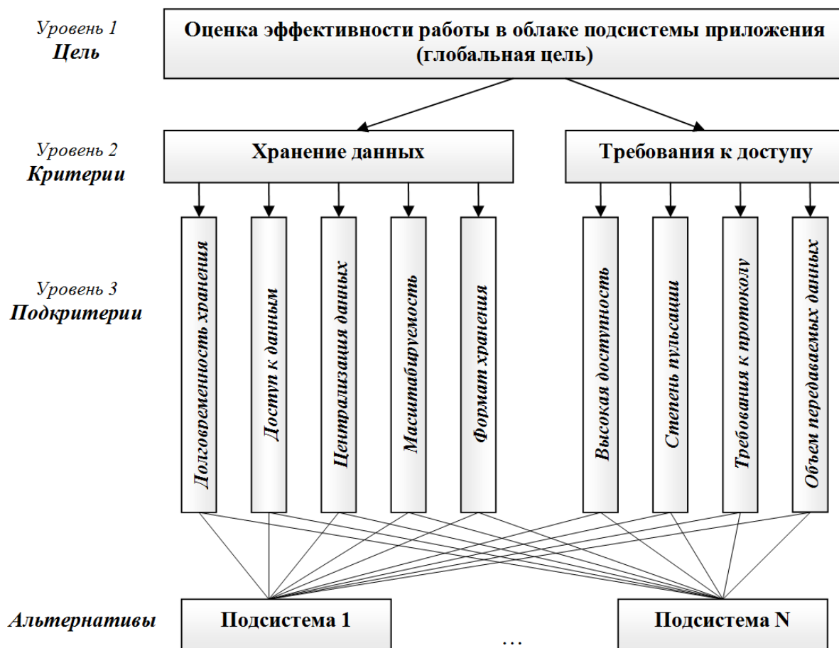
Рис. 2. Схематическое представление иерархии «цель–критерии оценки–альтернативы» МАИ для оценки технической возможности работы в облаке подсистем приложения.
